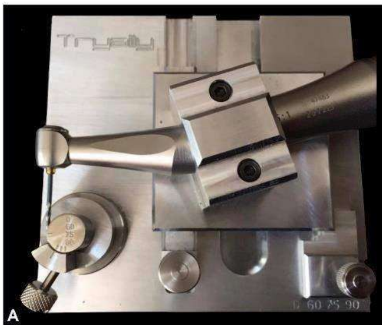
Figura 3: Imagem representativa do aparato de fadiga cíclica que será utilizado no ensaio.
