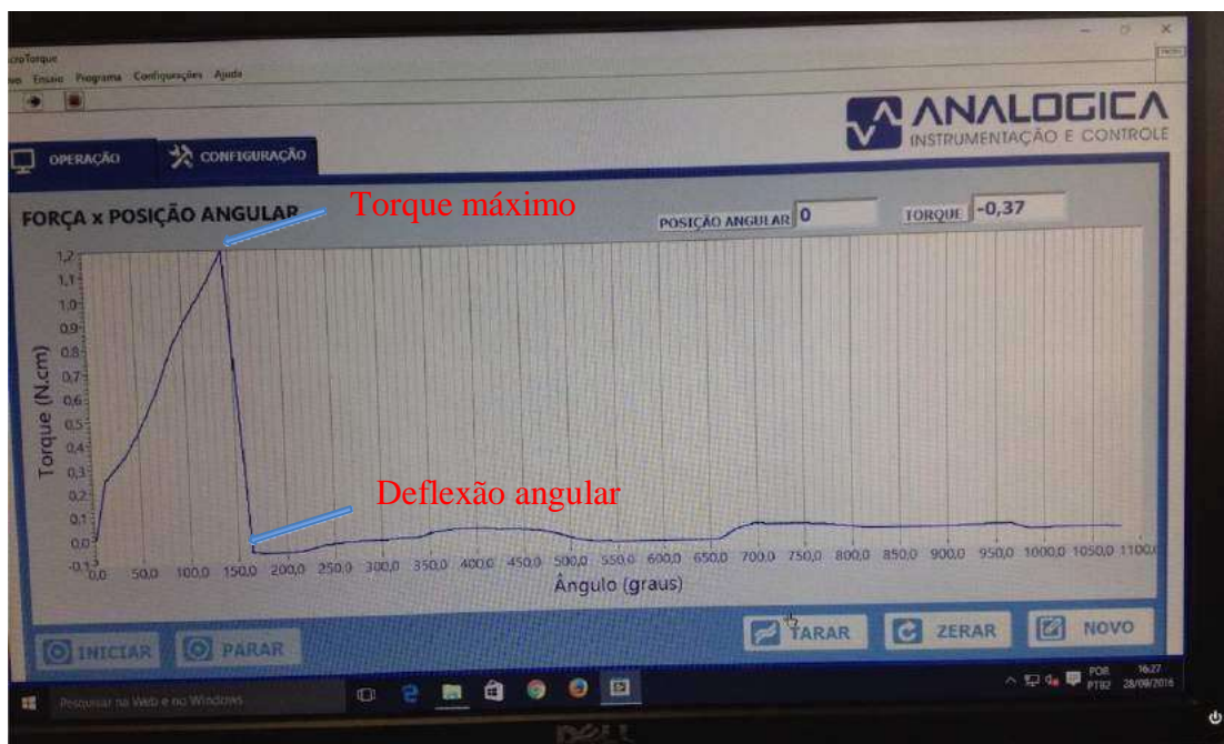
Figura 2: Imagem do software que fornecerá os valores de torque máximo (N.cm) e deflexão angular ( ^{\circ} ) para a fratura dos instrumentos.
