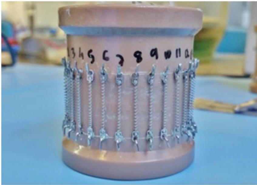
Figura 1: Tubo de PVC com as molas numeradas
