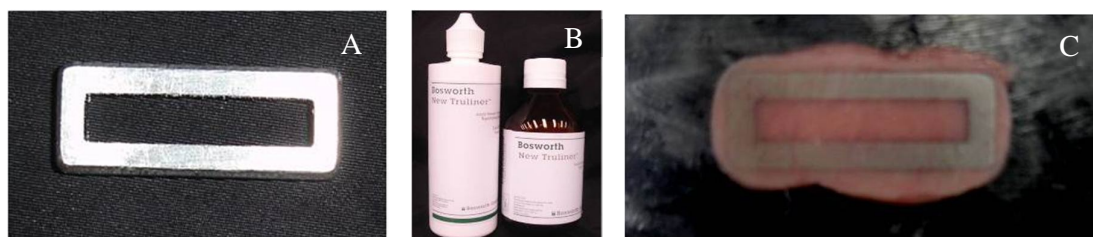
Figura 2: Confeção dos corpos de prova. Matriz metálica utilizada (A). Resina acrílica para reembasamento (New Truliner) (B). Preenchimento da matriz com a resina (C).
