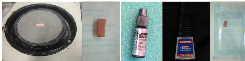
Figura 3: Lixamento dos corpos de prova na poltriz. (A) Corpo de prova após lixado com sua superfície rugosa identificada e voltada para cima. (B) Polidor líquido Biscover® (C) Adesivo Super Bonder® (D) Corpo de prova após voltar da esterilização (E)
