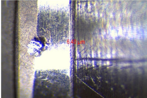
FIGURA 2 - AFERIÇÃO DO DESAJUSTE VERTICAL EM PILAR DE TITÂNIO. A ESQUERDA DA INTERFACE O IMPLANTE E A DIREITA O PILAR.(AUMENTO: 60x)
