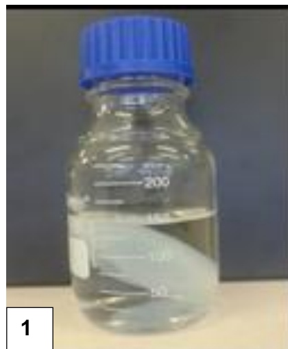
Figura 1 - Membrana de Celulose Bacteriana sintetizada por Gluconacetobacter xylinus em processo de lavagem com água destilada para retirar sais.
