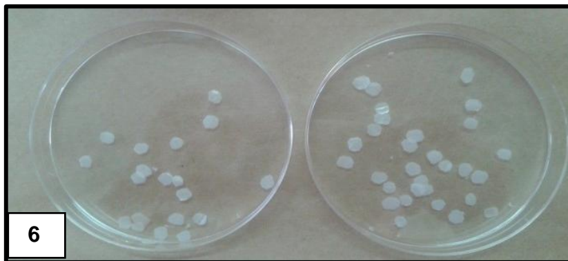
Figura 6 - Membranas recortadas em fragmentos de 0,5cm de diâmetro para serem esterilizadas por radiação \gamma (25kGy)
