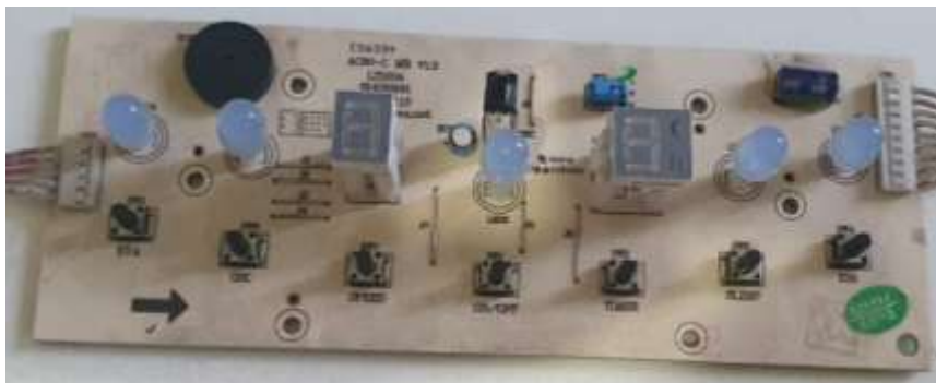
Figura 5 - Placa A do climatizador
