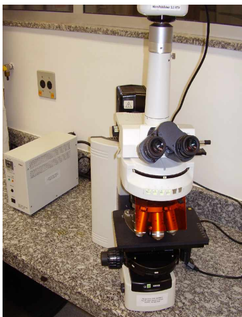
Figura 16: Microscópio óptico Nikon H550L Micro Publisher 3.3 RTU Equipamentos Eletrônicos Ltda.
