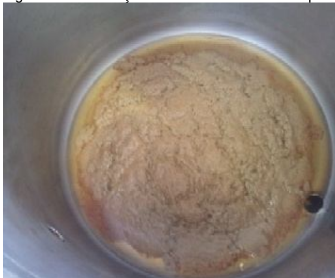
Figura 11 - Formação do trub no fundo do tanque
