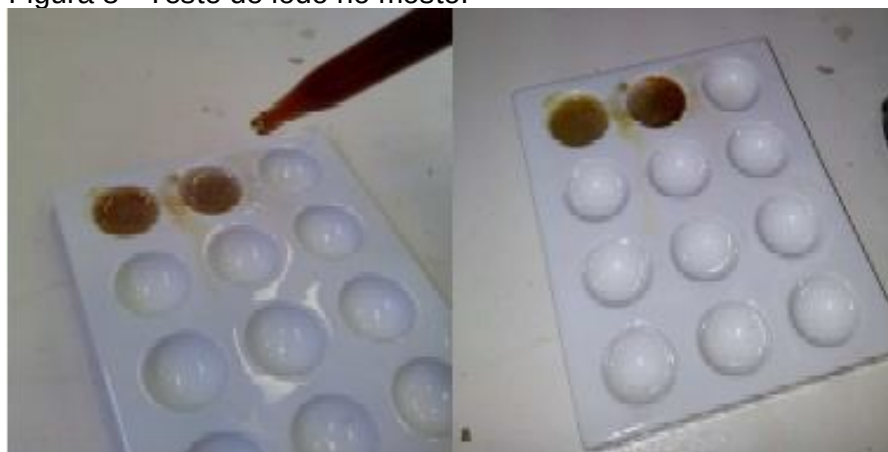
Figura 8 - Teste de iodo no mosto.
