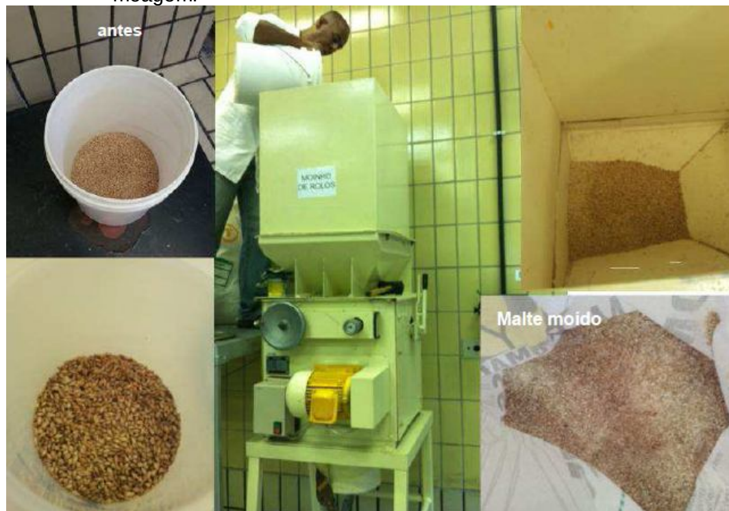
Figura 6 - Moagem do malte, comparação do grão antes da moagem e após a moagem.
