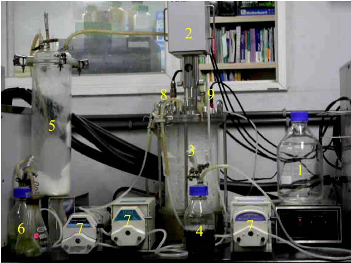
Figura 9 - Processamento de surfactina desenvolvido com rendimento de 6000 mg/L.
