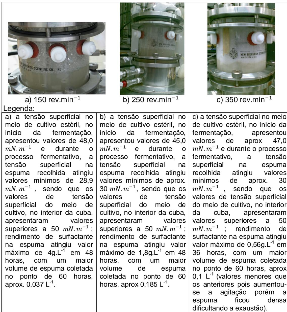
Figura 21 - Fermentações realizadas em diferentes rotações utilizando fermentador com cubas com volume útil de 1L e suas respectivas avaliações.
