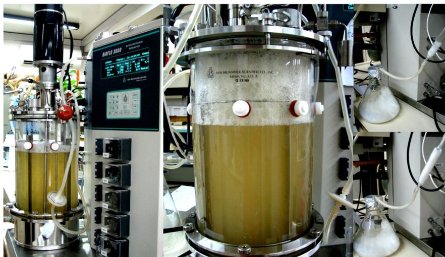
Figura 26 - Fermentação de 10 litros realizada em fermentador contendo meio de cultivo adicionado de glicerina residual como única fonte de carbono.
