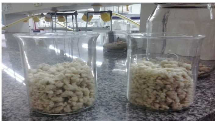
Figura 22 - Celulose obtida após o pré-tratamento. Fonte: Elaborado pela autora.
