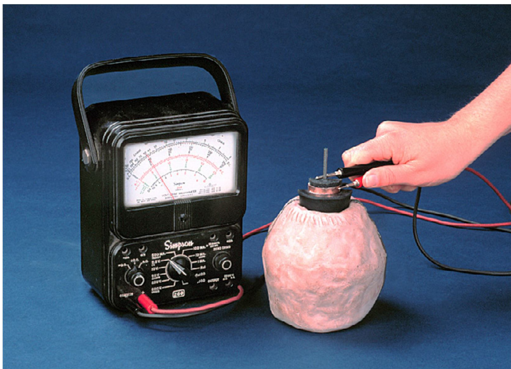
Figura 2- Cópia do artefato descoberto por Wilhelm Koenig, demonstrando a sua potencialidade como gerador elétrico.
