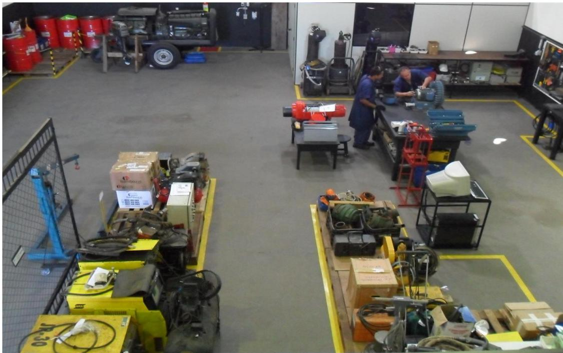
Figura 24 - Delimitação de área para entradas(esquerdo) e saída (direito) após a manutenção de equipamentos.
