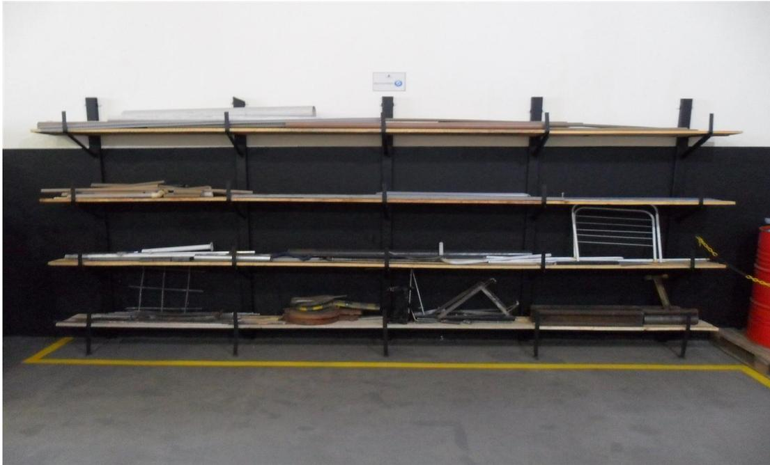
Figura 23 - Delimitação de área para materiais em não conformidade para o processo produtivo.
