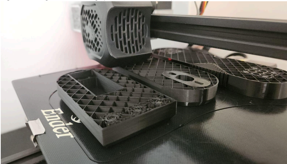
Figura 10 - Impressão 3D das peças estruturais do braço robótico
