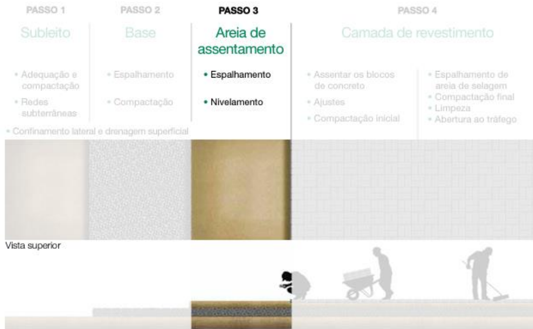
Figura 11 - Terceira etapa do processo de execução da pavimentação intertravada
