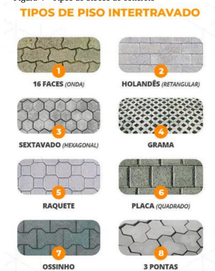
Figura 4 - Tipos de blocos de concreto
