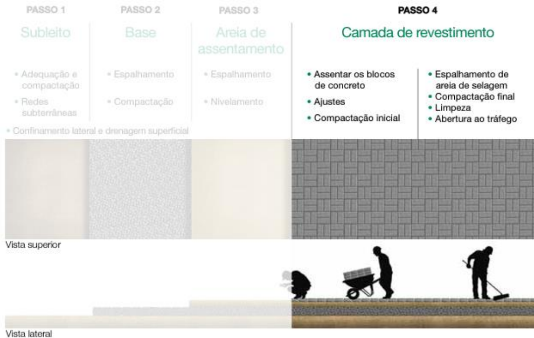
Figura 12 - Quarta etapa do processo de execução da pavimentação intertravada
