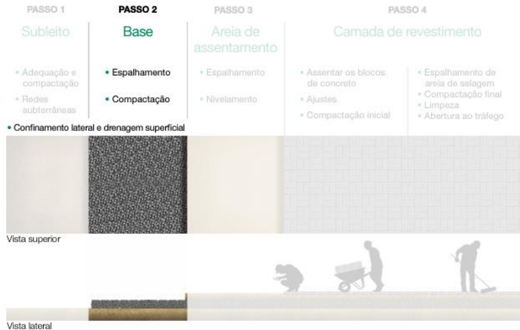
Figura 10 - Segunda etapa do processo de execução da pavimentação intertravada
