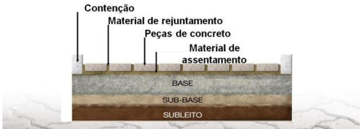
Figura 8 - Detalhamento estrutural da pavimentação em pavers
