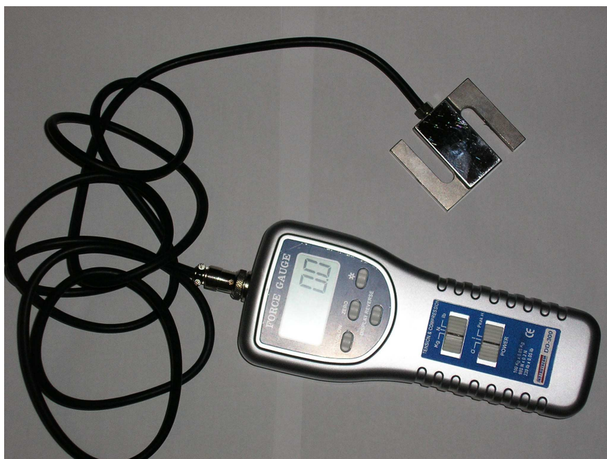
Figura14- Dinamômetro digital acoplado a célula de força.
