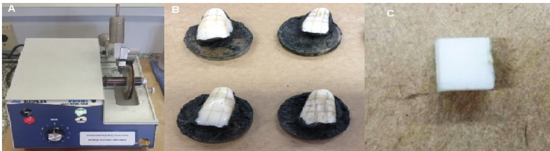
Figura 2 A) Cortadeira de precisão com discos diamantados; B) Coroa fixada em disco de resina; C) Espécime de esmalte no tamanho 4 x 4 mm.
