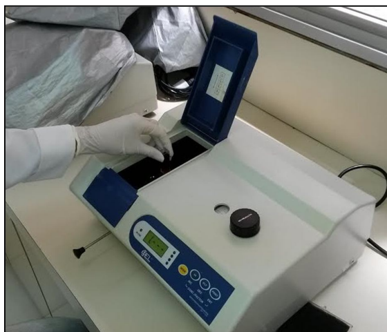
Figura 4 - Leitura em espectrofotômetro da concentração de proteínas e atividade. Fonte: Elaborado pela autora.
