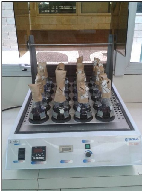
Figura 3 - Incubação dos controles iniciais de produção em agitador orbital a 30°C e 100 rpm.
