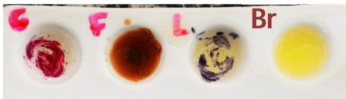
Figura 16 - Resultado qualitativo do Microteste com a adição do reativo FORREST para o fármaco barbitúrico
