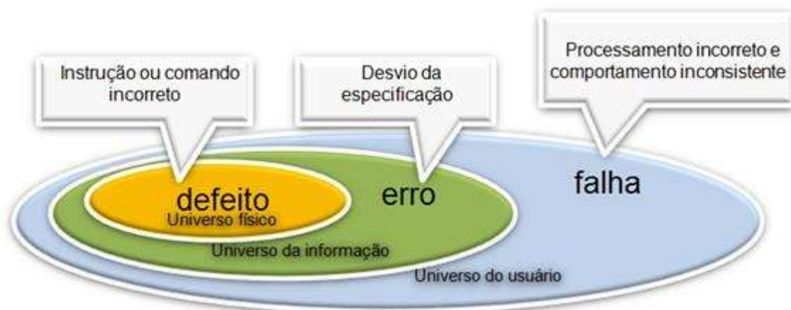
Figura 1 – Defeito x erro x falha
