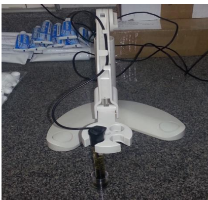
Figura 4: Eletrodo específico para o íon flúor. Fonte: Elaborada pelo autor
