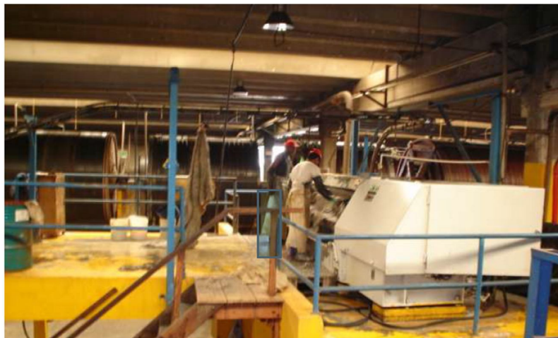
FIGURA 12 - Máquina descarnadeira-remoção da carnaça aderida à superfície interior ou inferior das peles. Fonte: SÃO PAULO (2005, p. 20).
