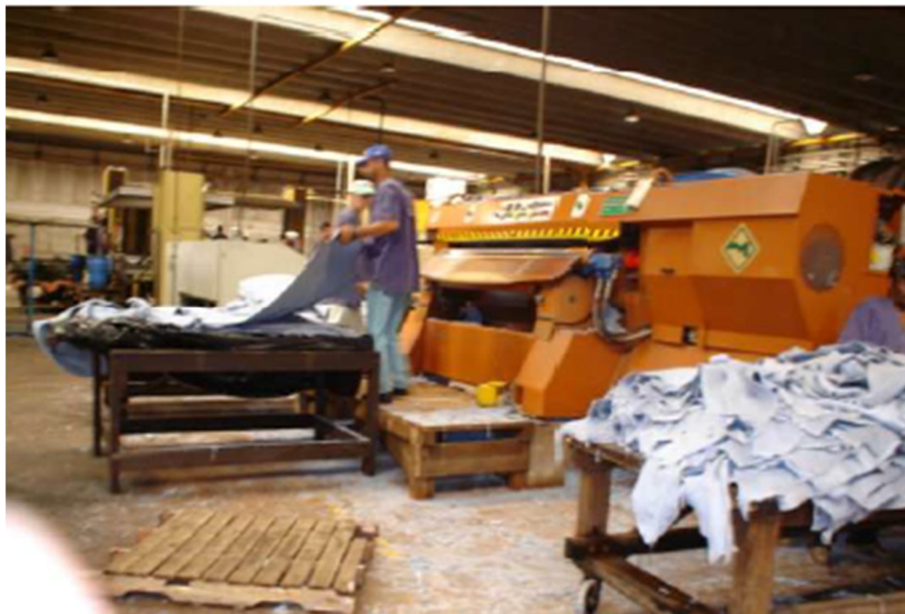
Figura 14 - Máquina da seção de rebaixadeiras-rebaixamento dos couros recém-curtidos ao cromo (“West-blue”) para ajuste de sua espessura. Fonte: SÃO PAULO (2005, p. 22).
