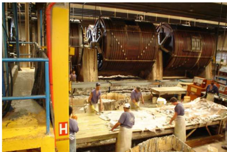
Figura 13 - Operação de recorte e ajuste das extremidades das peles, após descarne e/ou divisão. Fonte: SÃO PAULO (2005, p. 20).
