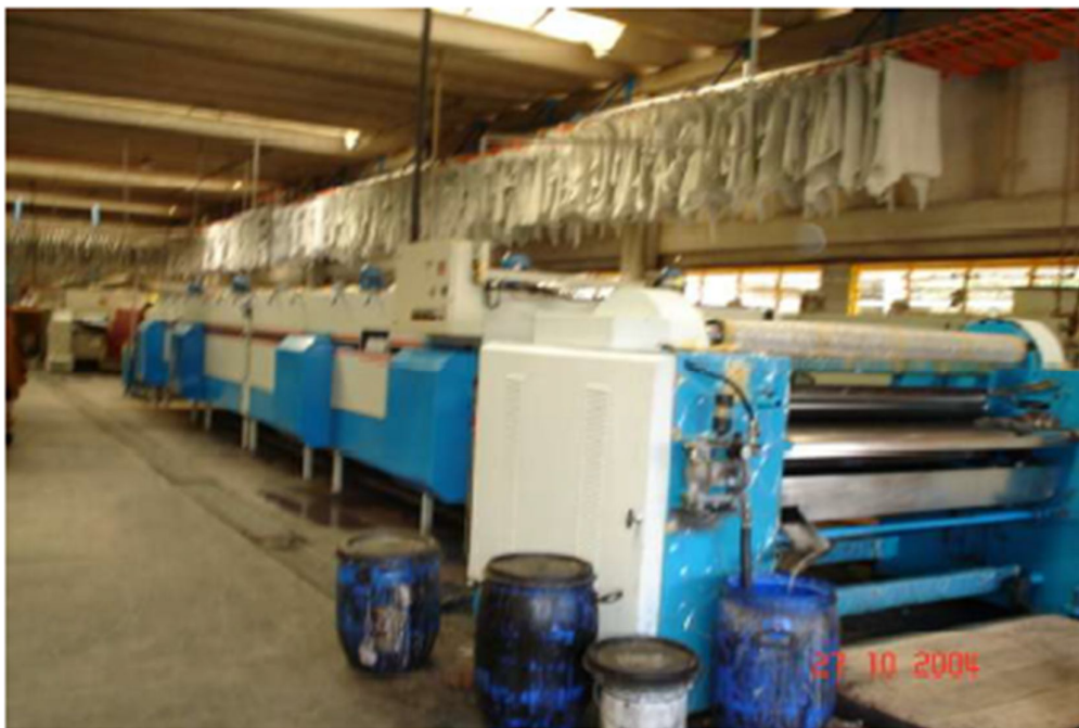
Figura 16 - Máquina da seção de acabamento-aplicação de produtos químicos à superfície dos couros. Fonte: SÃO PAULO (2005, p. 23).
