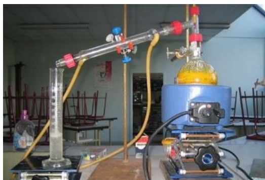
Figura 4 – Método de Hidrodestilação Fonte: Métodos... (2011).
