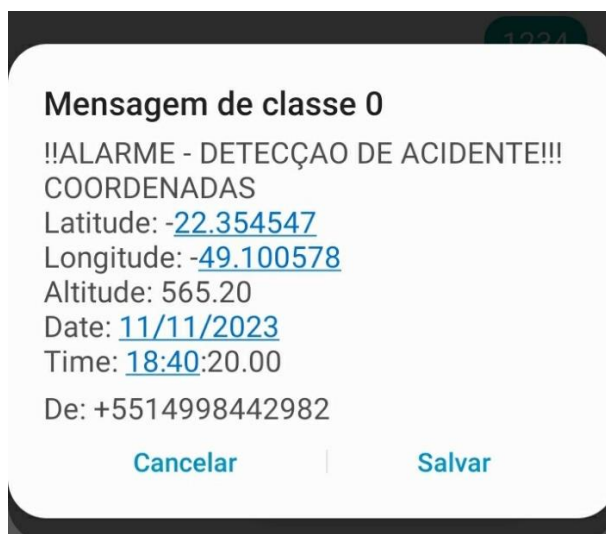
Figura 15 - SMS de classe 0 recebido pelo Celular, indicando a disparo do alarme.
