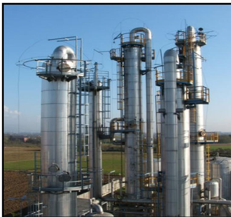
**Figura 13 - Colunas de destilação.**
