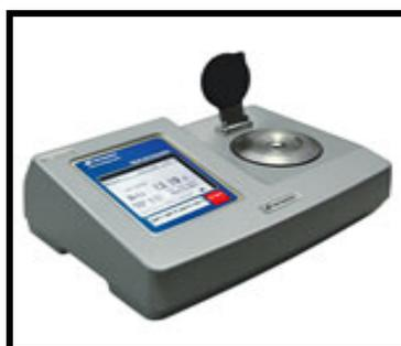
**Figura 9. Aparelho que mede a concentração do Brix.**
