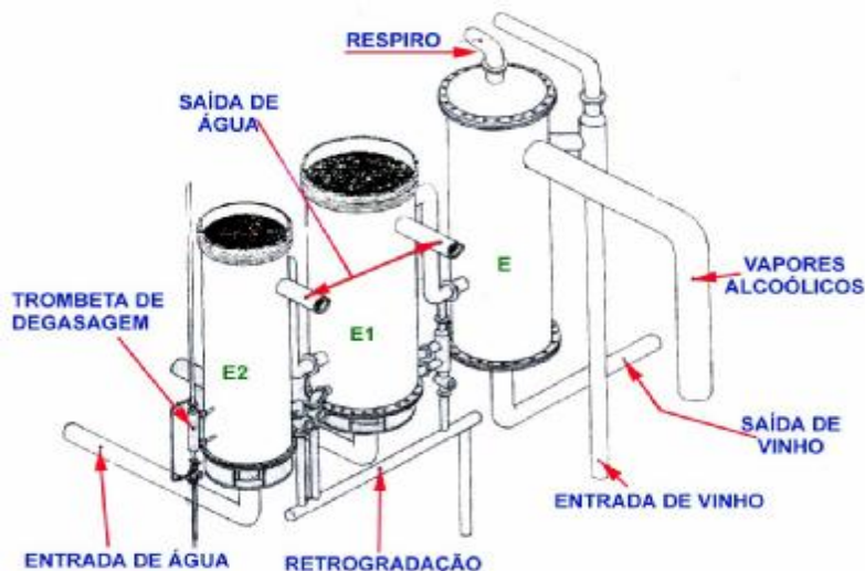
Figura 13 - condensadores E, E1 e E2
