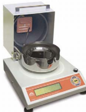
Figura 3 – Analisador de Umidade por Infravermelho. GEHAKA, Modelo IV-2002
