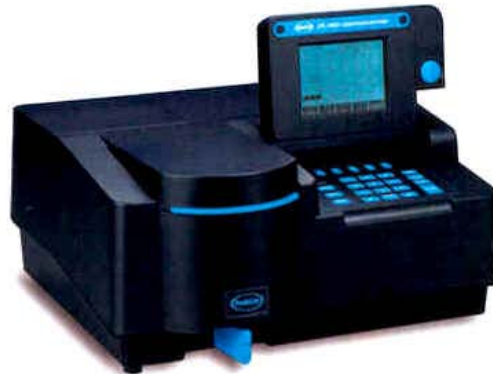
Figura 2 - Espectrofotômetro UV-vis. HACH, Modelo DR 4000 U
