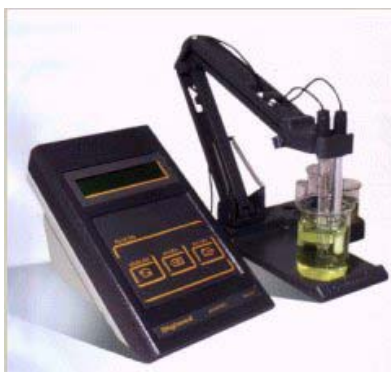
Figura 4 – Medidor de Íons/pH-metro. Orion, Modelo 710 A Fonte: Disponível em: < www.profcupido.hpg.ig.com.br >. Acesso em 20 set. 2007
