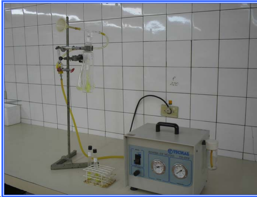
Figura 4 - Esquema utilizado para coletar as amostras de ar nos laboratórios empregando uma bomba, e tubos de sílica com DNPH.
