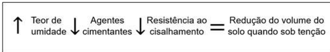
Figura 3 – Conseqüência devido o enfraquecimento nas ligações
