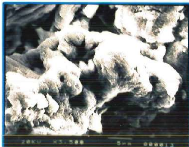
Figura 1 – Partículas de silte e argila, com elevada quantidade de microporos, presente na profundidade de 4,00m
