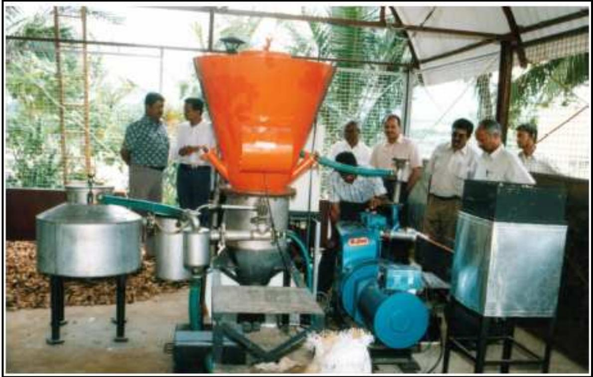
Figura 4 – Gaseificador utilizado para produção de energia elétrica
