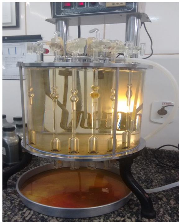
Figura 9- Banho viscosímetro Atlantic
