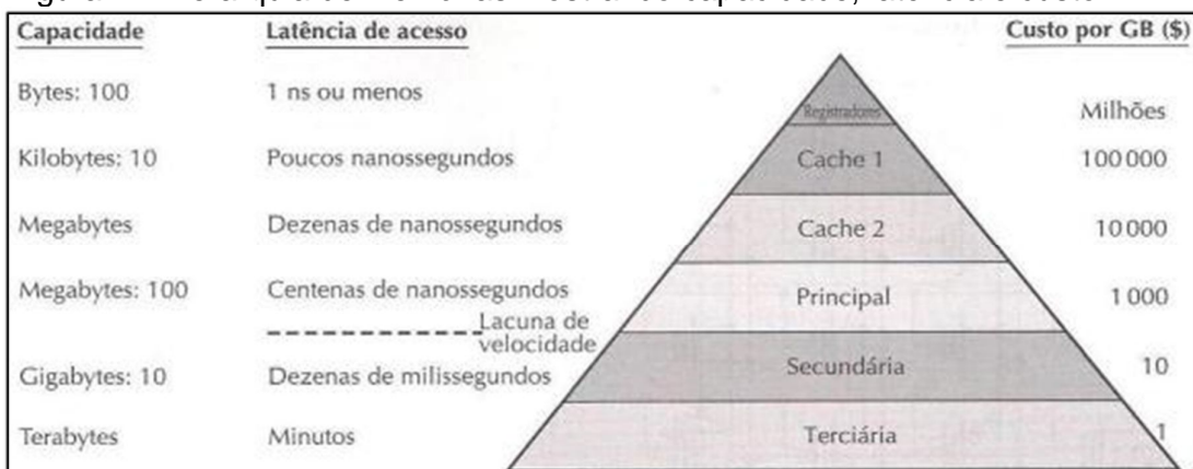
Figura 4 - Hierarquia de memórias mostrando capacidade, latência e custo
