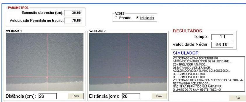
**Figura 31 – Simulador retornando um resultado com velocidade acima do permitido.**
