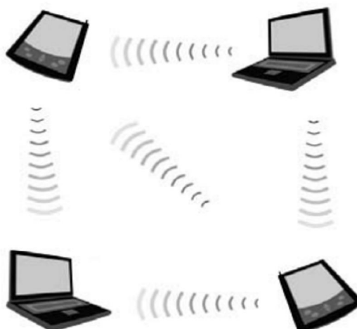
Figura 5 – Topologia de rede no modelo Ad-Hoc
