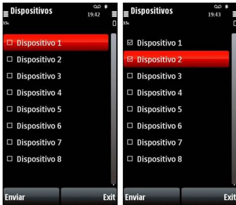
Figura 6-11 - Aplicativo do dispositivo móvel sem nenhum dispositivo ativo e com os dispositivos 1 e 2 ativos.
