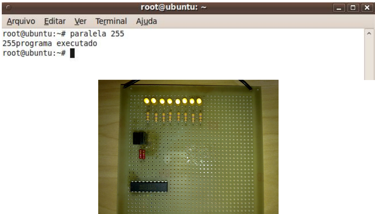
Figura 6-9 - Execução do aplicativo passando o byte 255 como parâmetro e o circuito com todos os LEDs ativos
