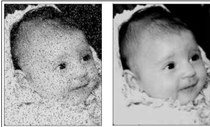
Figura 3 – Exemplo de antes e depois da aplicação do filtro de mediana
