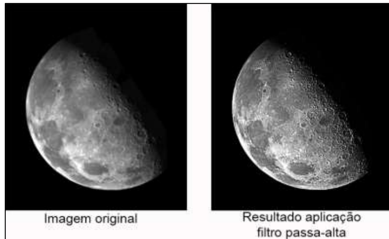
Figura 4 – Exemplo de resultado da aplicação de filtro passa-alta
