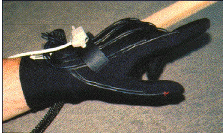
Figura 3.1.3 – Luva de Zimmerman e Lanier (MACHADO, 1995)
