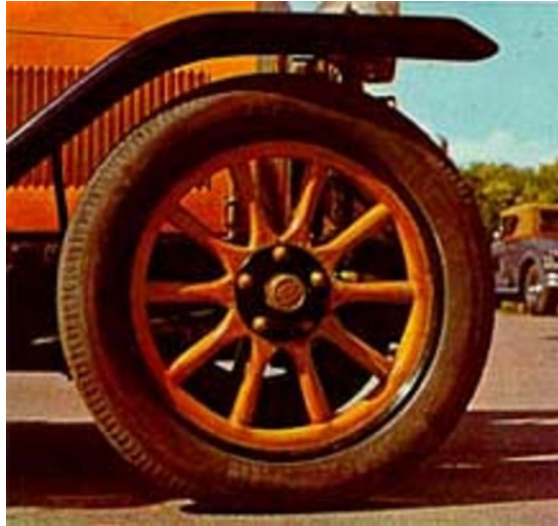
Figura 2.1.1 - Roda construída com raio e aro de madeira, de 1907. (Fonte: http://www.carroantigo.com ).
