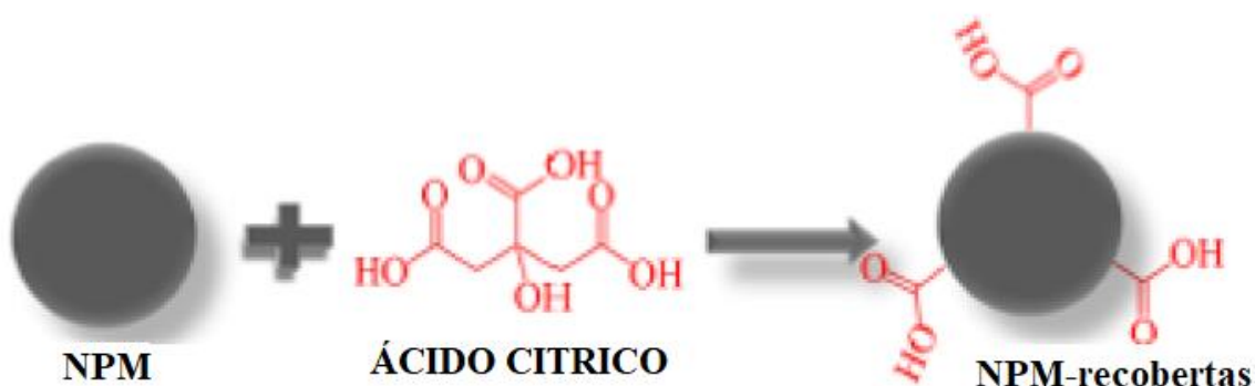
Figura 11 – Nanopartículas magnéticas recobertas com ácido cítrico.
