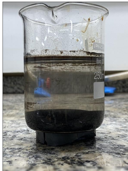
Figura 8 – decantação magnética das nanopartículas de magnetita.
