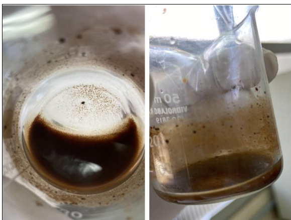
Figura 18 – NPM oxidadas após armazenadas por um curto período.
