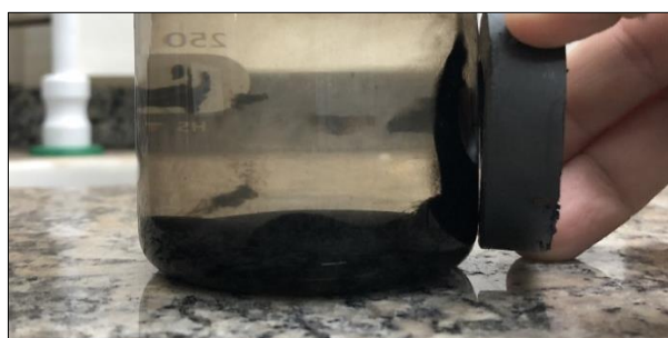
Figura 17 – NPM atraídas pelo imã após a síntese.
