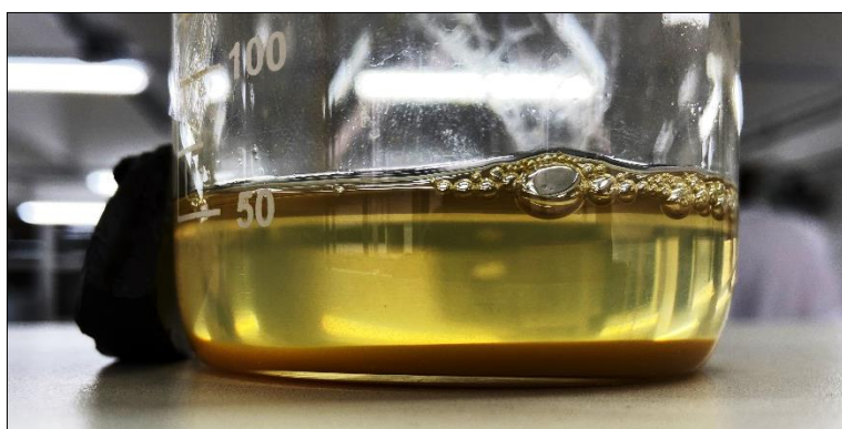
Figura 27 – NPM oxidada com baixa magnetização.
