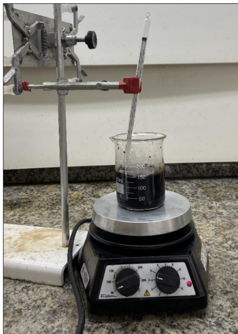
Figura 7 – Checagem da temperatura da síntese das NPM.
