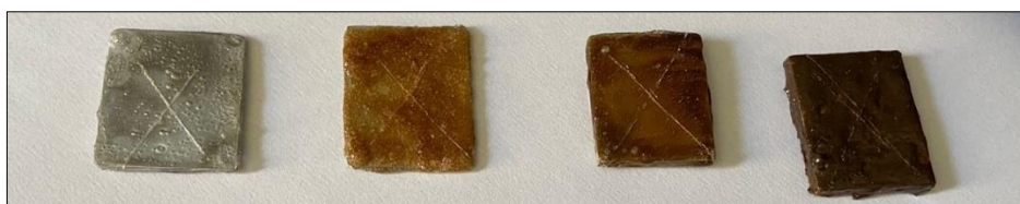
Figura 15 – Amostras com os cortes em X, da esquerda pra direita: só tinta, tinta com 0,1% de FM; tinta com 1,0% de FM; e tinta com 10,0% de FM.
