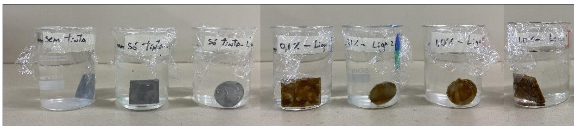
Figura 23 – Amostras nos beckeres com NaCl e o hidróxido de alumínio.
