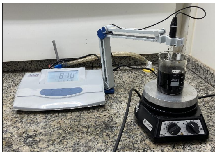
Figura 9 – Checagem do pH da síntese das NPM.
