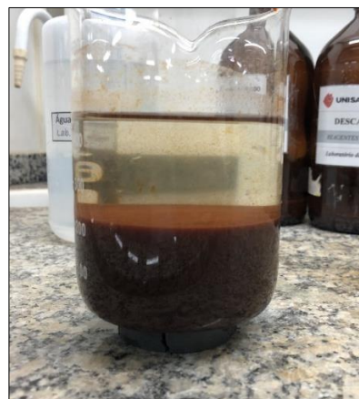
Figura 19 – Oxidação da magnetita para maghemita com tratamento térmico.
