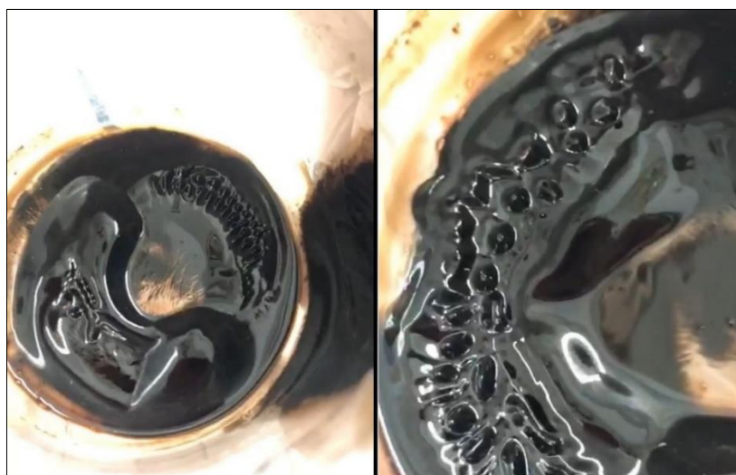
Figura 20 – “Porco Espinho” das NPM após recobrimento com ácido cítrico.
