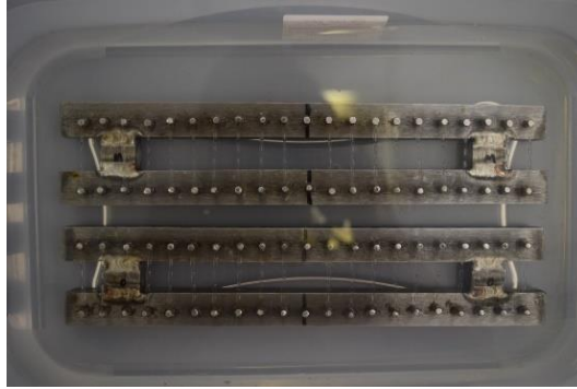
FIGURA 3: Estruturas com os elásticos distendidos, submersos em saliva artificial.
