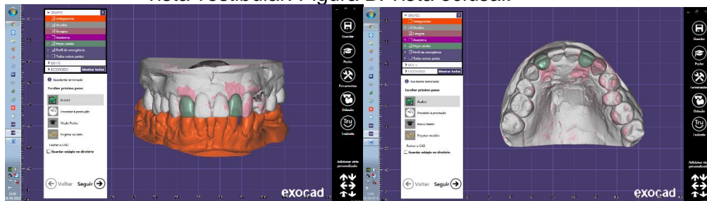
Figura 12. Figura A: Obtenção da coroa de revestimento no software CAD/CAM, vista vestibular. Figura B: vista oclusal.
