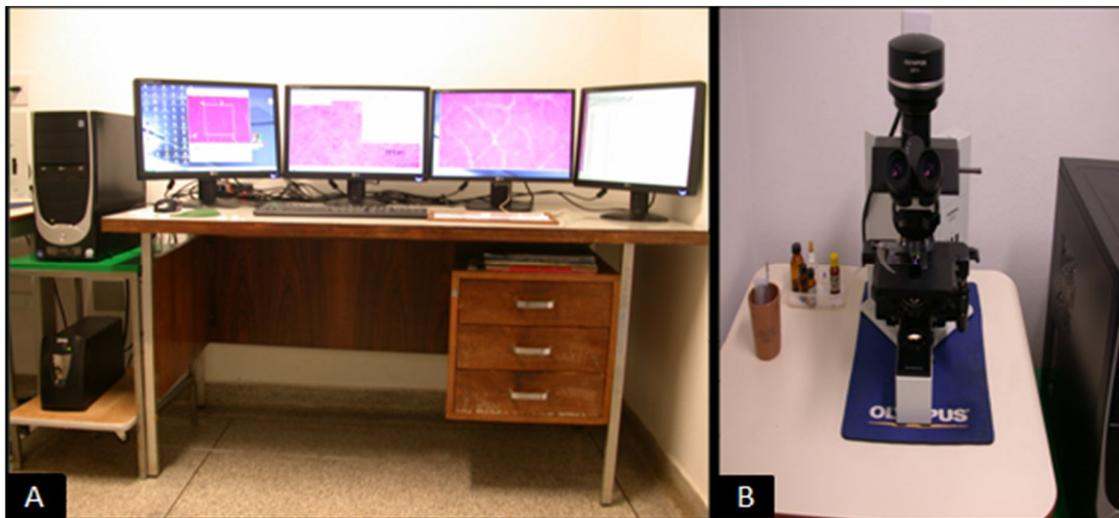
Figura 4 - Fotomicrografia do equipamento usado para análise das amostras. Sendo, A: Computador e monitores usados para a análise das fotos, B: Fotomicroscópio acoplado ao computador.
