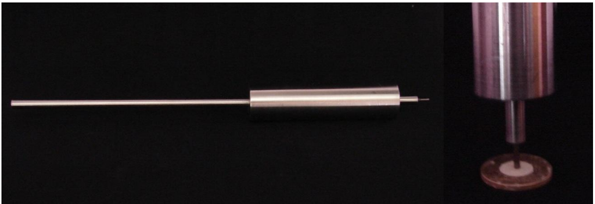
Figura 2 - Agulha de Gilmore de 453,5 gramas empregada na determinação do tempo de presa final.
