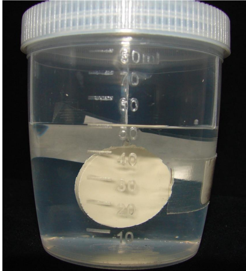
Figura 3 - Corpo de prova imerso em 50 mL de água MilliQ para o teste de solubilidade.
