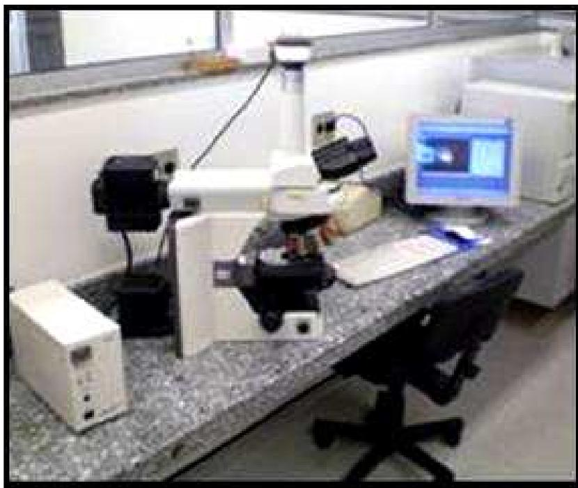
**Figura 10:** Fotomicroscópio *Nikon Eclipse 80i*, acoplado a um analisador de imagens (Image Pró-Plus® 5.1).
