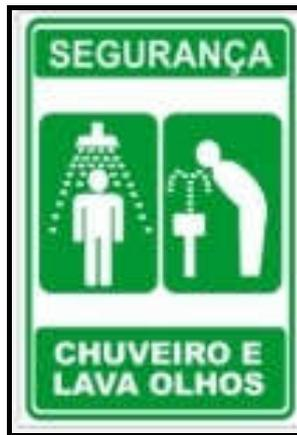
Figura 22 - Simbologia utilizada para sinalizar um lava olhos e um chuveiro de emergência
