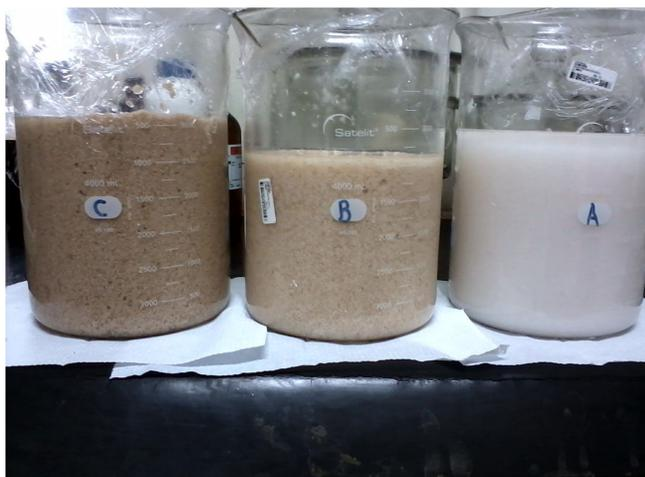
Figura 3 - Processo de polpação do lodo primário do processo Kraft para a obtenção da microcelulose utilizando processo químico-hidrotérmico: c) após primeira explosão; b) após segunda explosão; a) após terceira explosão. Fonte: Elaborado pela autora.
