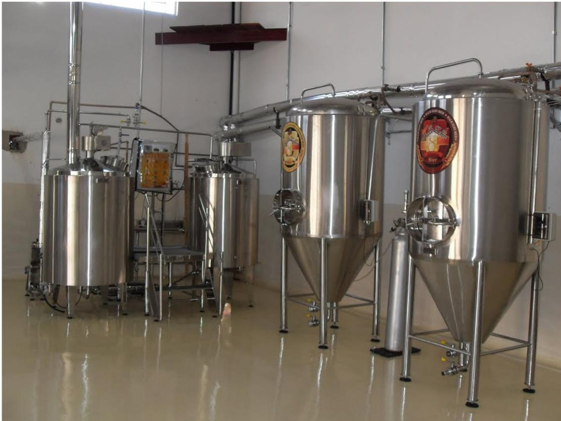
Figura 9 - Fermentadores utilizados na produção do ácido glutâmico.
