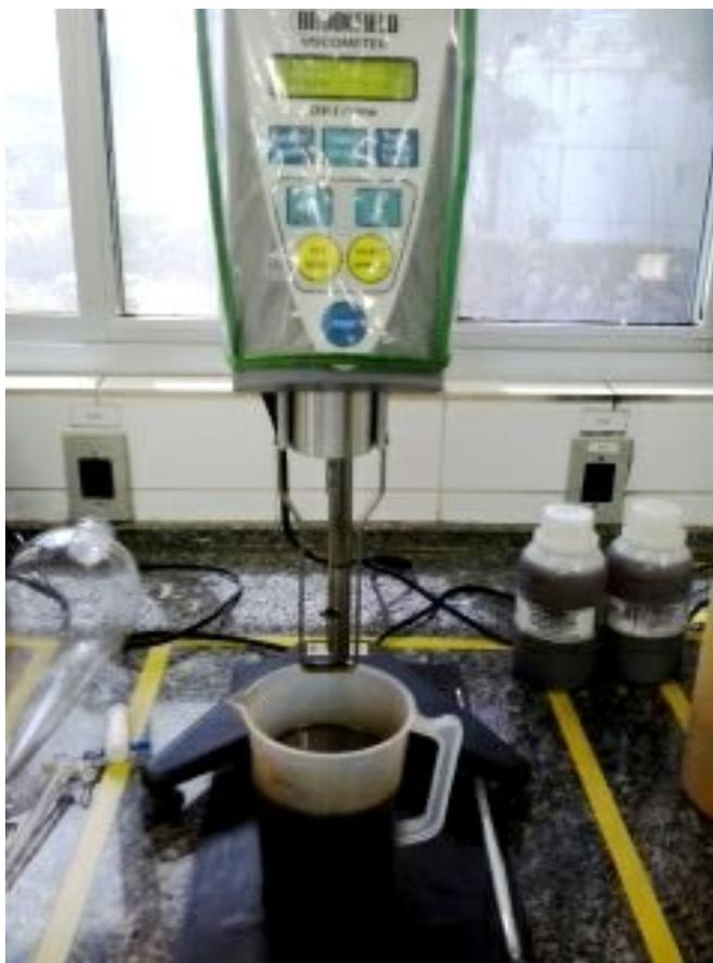
Figura 4- Medição da viscosidade através do equipamento Viscosímetro.
