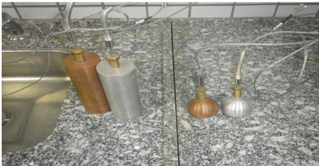
Figura 5 - Corpos de prova utilizados no experimento.
