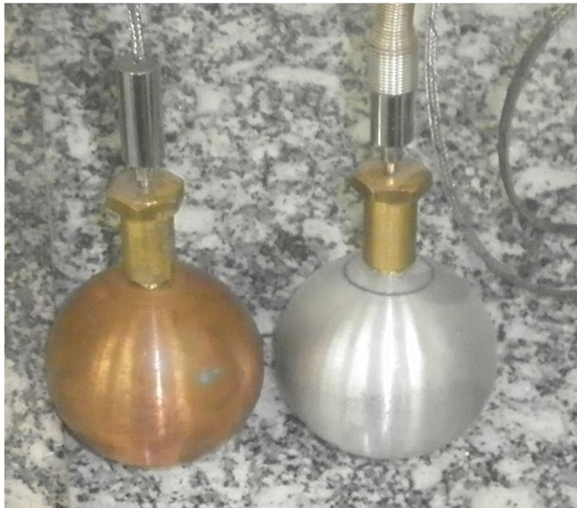
Figura 6 - Corpos de prova esféricos utilizados no experimento.
