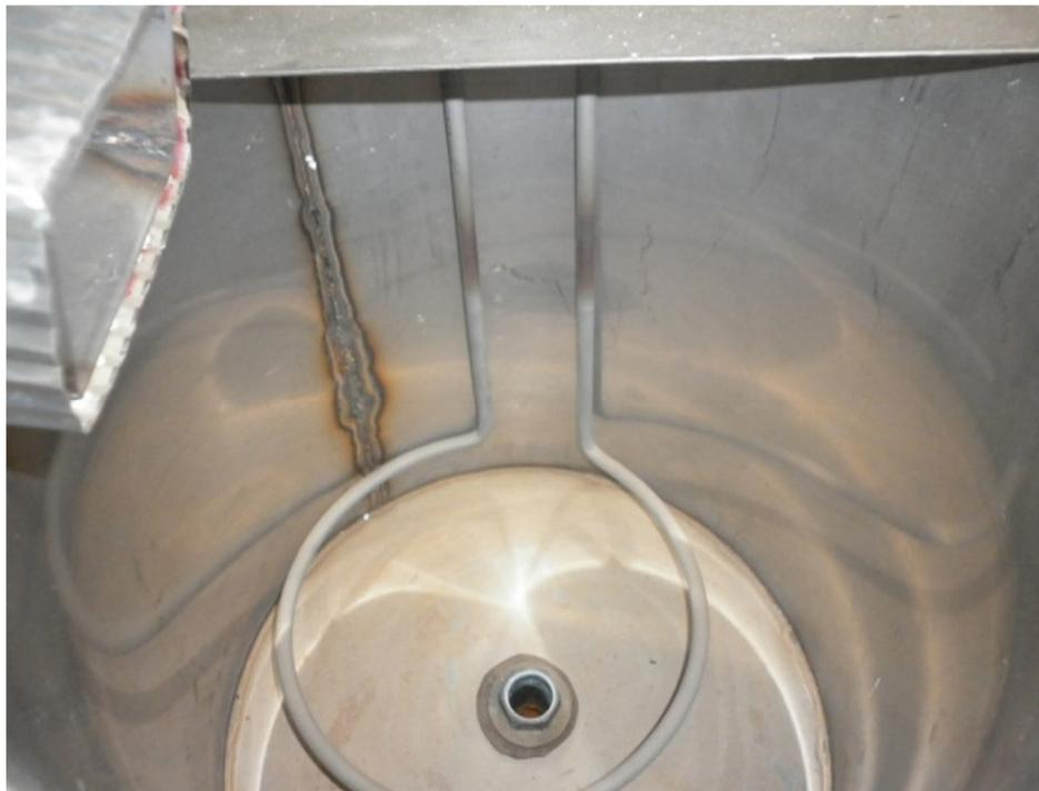
Figura 11 - Resistência elétrica (Fio Kanthal) para aquecimento do fluido de imersão
