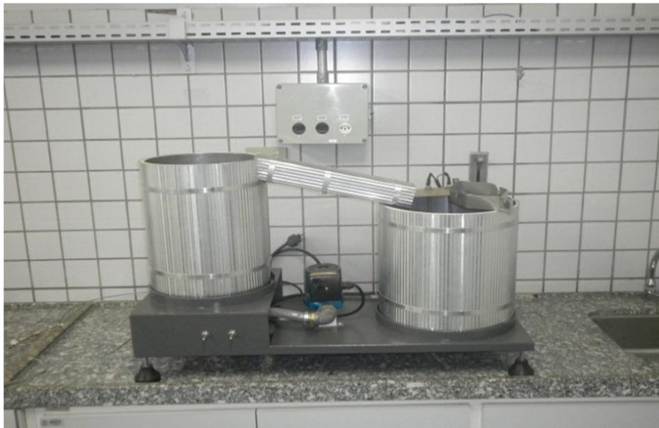
Figura 4 - Aparelho que simula a condução transiente em corpos submersos.
