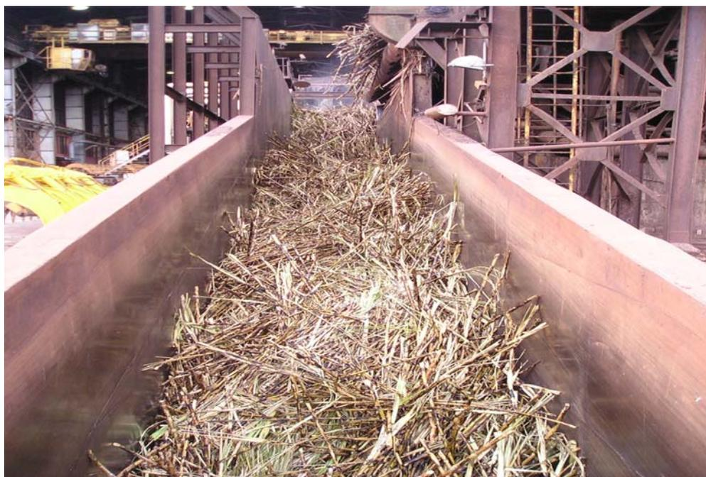
Figura 3: esteira metálica
