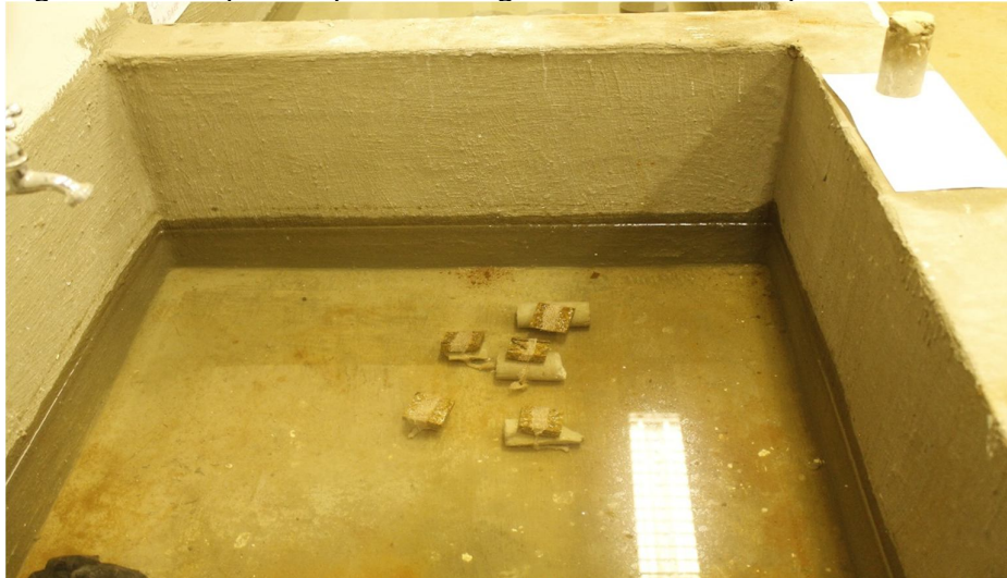
Figura 34 - Corpos de provas mergulhado em um tanque.
