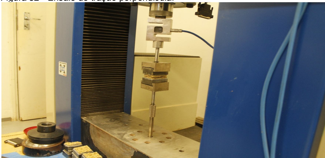
Figura 32 - Ensaio de tração perpendicular
