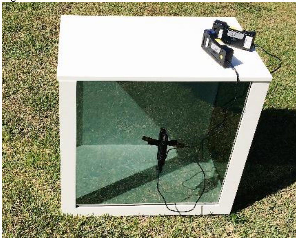
Figura 14 - Vidro laminado refletivo "cool lite linha S - 436ST-Green"
